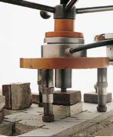
Badanie przyczepności metodą SATTEC
