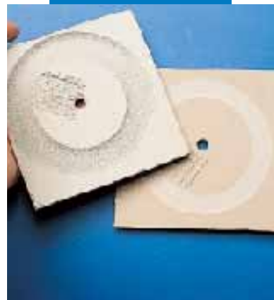
Próba ścierania wg Taber'a na Ultraplan (próbka prawa) oraz próba na tradycyjnej masie (próbka lewa) po 200 obrotach
